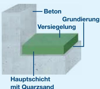
Nach der Beschichtung der Grundierung wird die Hauptschicht, verstärkt mit Quarzsand, in der gewünschten Farbe aufgetragen. Durch den Quarzsand entsteht eine glatte, selbstnivellierte Oberfläche. Eine transparente Versiegelung garantiert eine lange Haltbarkeit.
