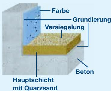
Um einen belastbaren und trittfesten Laufbereich zu schaffen, muss zuerst eine schützende Grundierung aufgetragen werden. Die Hauptschicht wird mit Quarzsand in der gewünschten Farbe abgestreut. Dies sichert den Halt beim Laufen. Die Oberfläche wird anschließend mit einer transparenten Versiegelung für eine lange Haltbarkeit abgeschlossen.
