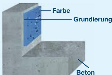
Nach der zweifachen Applikation der Grundierung folgt eine Lage Wandfarbe im gewünschten Farbton. Für eine dekorative Oberfläche können zusätzlich Dekorfloken eingestreut werden.
