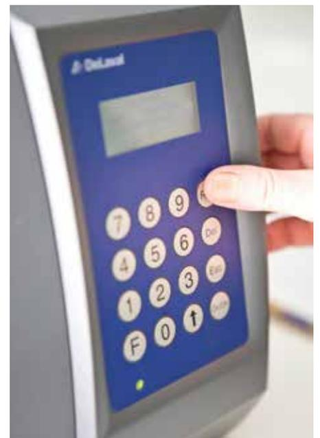
Das Messergebnis wird in nur 45 Sekunden angezeigt und kann mittels Datenkabel auf den PC übertragen werden.
