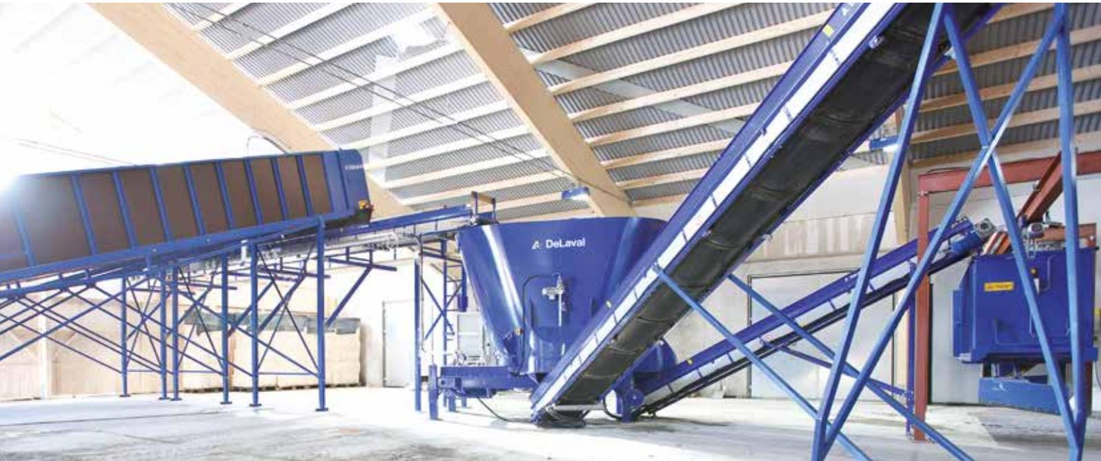
Das Optimat™ System basiert auf einer Vernetzung von Spezialisten für jeden Arbeitsschritt. Ein robuster vertikaler Stationärmixer sorgt für eine gründliche Mischung aller zu ladenden Komponenten bis hin zu Rundballen. Ein frequenzgesteuerter Motor sorgt dafür, dass immer nur die Leistung abgerufen wird, die auch wirklich benötigt wird.
