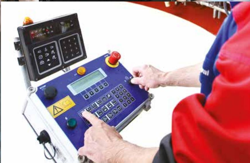
HBR-Bedienpult RC90 – volle Kontrolle über den Kuhverkehr sowie Abruf der Melkdaten und Statusinformationen eines jeden Melkplatzes ohne Laufwege.
