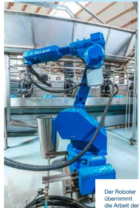
Der Roboter übernimmt die Arbeit der Zitzensinfektion nach dem Melken
