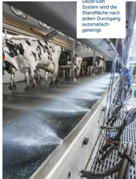
Mit dem DeckFlush System wird die Standfläche nach jedem Durchgang automatisch gereinigt.
