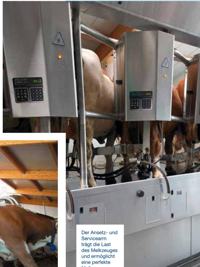
Der Ansetz- und Servicearm trägt die Last des Melkzeuges und ermöglicht eine perfekte Melkzeugpositionierung.
